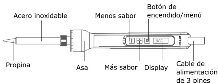
Se preprograman 9 **ubicaciones de memoria de temperatura**, que se pueden seleccionar con +/- . Para cambiar una temperatura almacenada, selecciónela y luego cámbiela en el menú.
