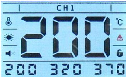
Die Lötstation hat eine integrierte ESD-Test-Funktion.
